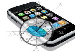
Les gyroscopes qui équipent certains smartphone servent à repérer précisément la **position** et l'**orientation** de l'**appareil dans l'espace**.
